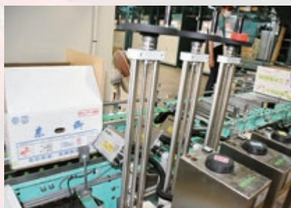
インクジェットプリンターでの吹き付け作業の様子
