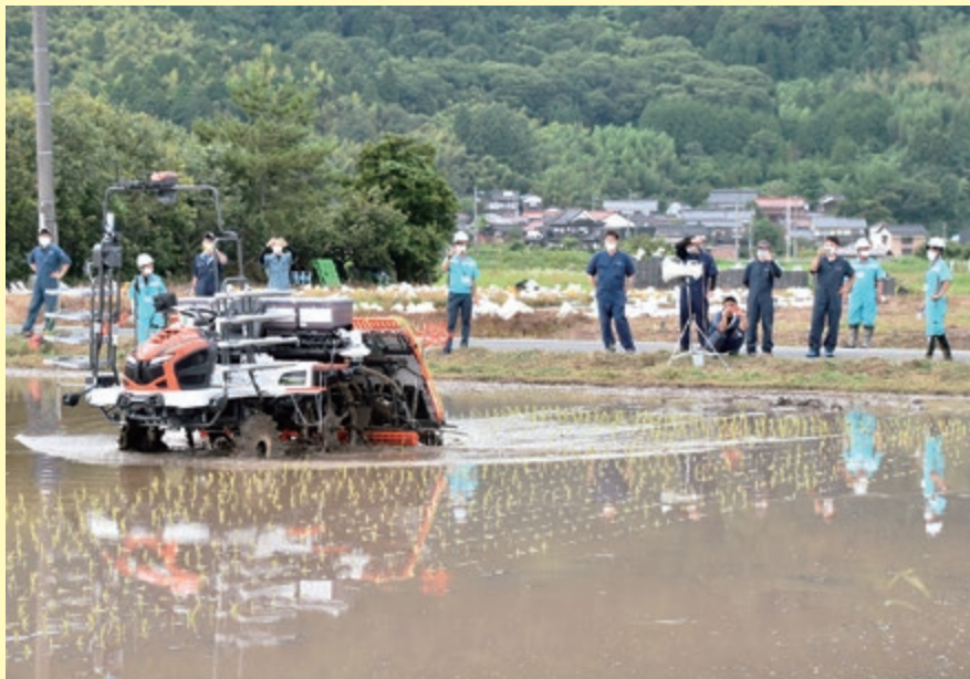
無人で植付を行う最先端技術搭載の田植機
