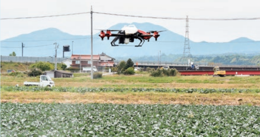
ほ場の形を登録すると自動で走行し、薬剤を散布するドローン
